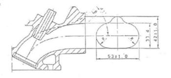
II Inlet manifold ports, cylinderhead side (tolerances on dimensions: -2%, +4%) インナークマニホールドボート、シリンデーヘッド調 (寸注2表: -2%+4%)
