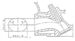
N Exhaust manifold ports, cylinderhead side (tolerances on dimensions: -2%, +4%) エキゾーストマニホールドボート、シリンダーヘッド間 (寸注企業: -2%+4%)
