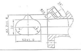
III Cylinderhead exhaust ports, manifold side (tolerances on dimensions: -2%, +4%) シリンダーヘッドエキゾーストボート、マニホールド類 (寸法公長:-2%+4%)
